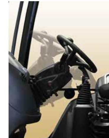
Высота, глубина и угол наклона рулевой колонки могут быть отрегулированы
